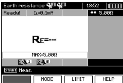
El medidor está listo a hacer la medición. En la pantalla se puede leer el valor de la corriente de fuga que fluye a través de la pinza.
