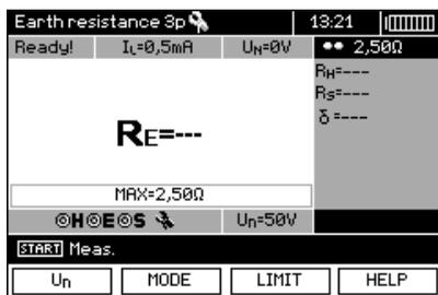
El medidor está listo a hacer la medición. En la pantalla se puede leer el valor de la tensión de interferencia  $U_N$  y el valor de la corriente de fuga que fluye a través de la pinza en el objeto estudiado.
