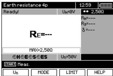
El medidor está listo para la medición. En la pantalla se puede leer el valor de la tensión de interferencia  $U_N$  en el objeto estudiado.
